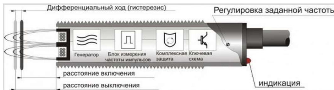
Рисунок 4 – Принцип действия индукционного датчика
