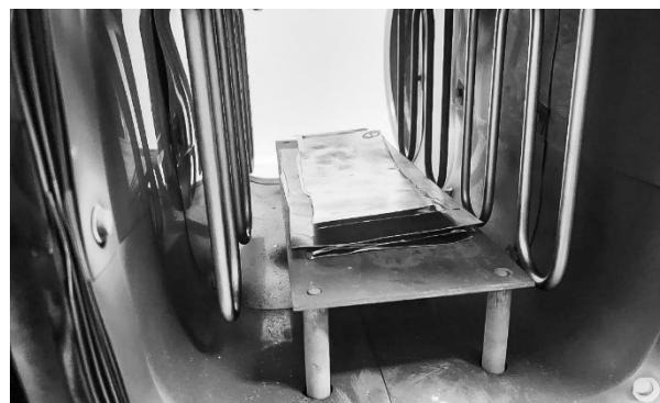
Рисунок 3 - Электропечь сопротивления камерная вакуумная Вега-1М с образцами ленты БрБ2 для старения
